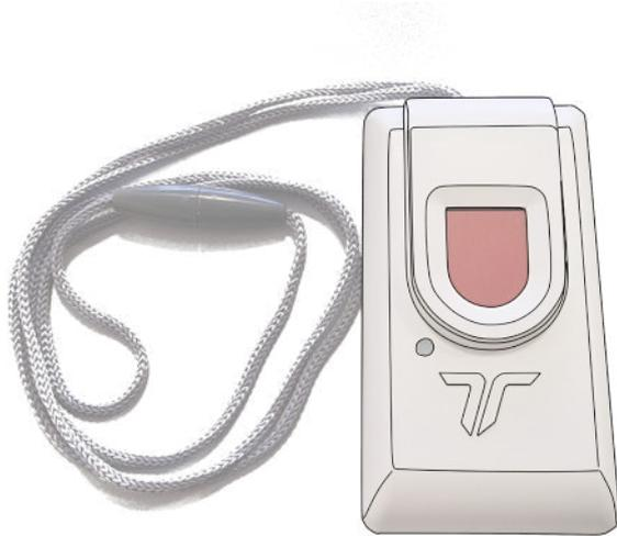
Sa taille compacte, son boîtier étanche et sa facilité de manipulation font de l'émetteur médaillon S35 l'outil idéal pour les habitations disposant d'un appareil de télé-assistance. L'alarme se déclenche en tirant sur le cordon ou en appuyant sur le bouton rouge. Un appel est alors envoyé à l'appareil de télé-assistance. L'émetteur médaillon S35 se porte en clip sur un vêtement ou autour du cou avec la tirette d'appel.
