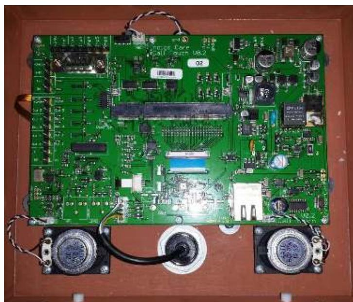
Pour retirer la carte COM de la carte mère, les loquets latéraux doivent être poussés sur le côté et la carte doit être retirée du connecteur en biais. Pour réinsérer la carte fille dans la carte mère, il faut l'enfoncer dans le connecteur à un angle d'environ 45° et appuyer dessus.
