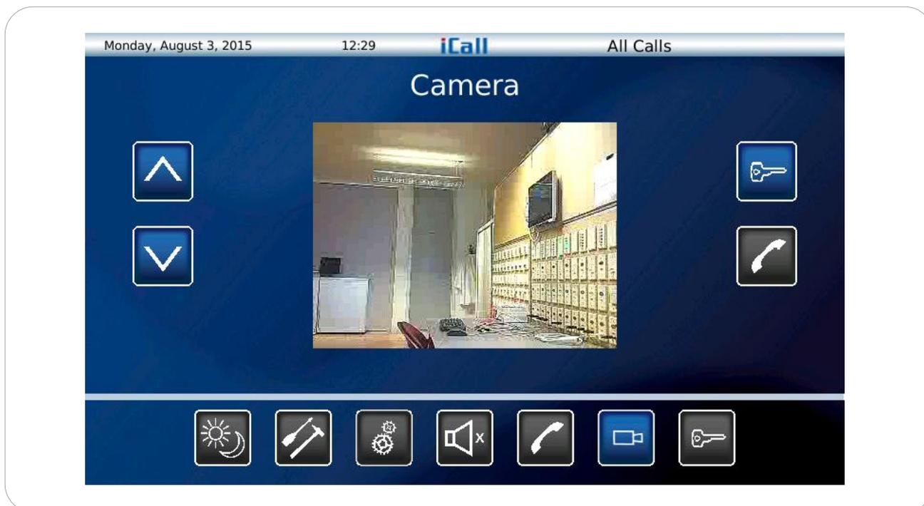
In der Kameraansicht können Sie auf maximal 10 Videoströme zugreifen.
