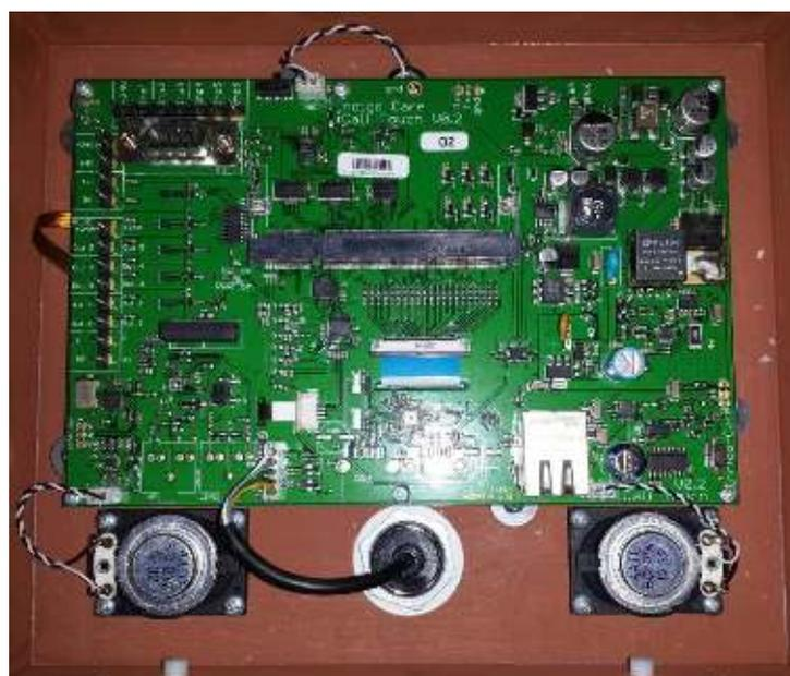
Um die COM-Karte aus der Grundplatine zu entfernen, müssen die seitlichen Verriegelungen zur Seite geschoben und die Karte schräg aus dem Steckverbinder gezogen werden. Um die Tochterkarte wieder in die Grundplatine einzusetzen, muss sie in einem Winkel von ca. 45° in den Steckverbinder geschoben und nach unten gedrückt werden.
