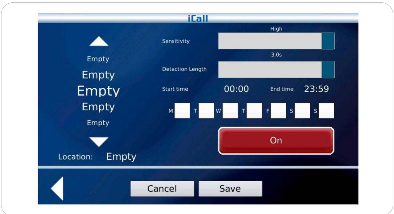
Die Schwesternstation kann zur Programmierung von akustischen Ruf-Tasten verwendet werden. Die Empfindlichkeit und Länge des akustischen Auslösers kann zusammen mit der Start- und Endzeit und dem Wochentag, an dem die akustische Einheit funktionieren soll, eingestellt werden. Durch Drücken der Einschalttaste wird sie in Betrieb gesetzt.
