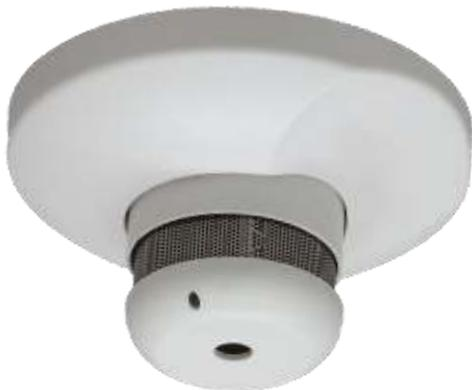
En cas de fumée due à un feu, le détecteur de fumée radio émet une tonalité locale d'un volume élevé et la LED clignote toutes les demi-secondes. Dans le même temps, le module radio transmet un signal à l'appareil de téléassistance qui, à son tour, déclenche un appel à la centrale d'alarme.
