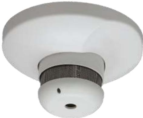
Im Fall von Rauchentwicklung durch Feuer alarmiert der Funk-Rauchmelder vor Ort durch einen lauten Alarmton. Gleichzeitig wird die Gefahr per Funk an die Haus-ServiceRuf-Teilnehmerstation gesendet, die den Alarm über die externe Verbindung weiterleitet.
