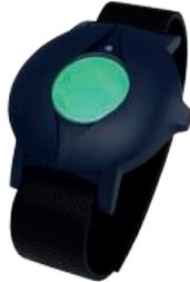
Der kabellose, programmierbare Armbandsender B80A mit Begleit- und Quittierfunktion ist ausschließlich für Fachpersonal bestimmt. Als Teil eines Schwesternruf-systems für Demenzkranke wurde er speziell entwickelt, um das Pflegepersonal dabei zu unterstützen, Patienten durch einen kontrollierten Bereich zu begleiten, ohne dabei Alarm auszulösen. Mit drücken der grünen Taste wird ein Kurzstrecken-Funksignal vom BA80A innerhalb eines Radius von 5 cm ausgelöst, der den Alarm am quittiert.
