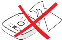
Wenn Flüssigkeit in die Lautsprecher oder Tasten des TA72 gerät, halten Sie das Gerät einfach mit der Oberseite nach unten, um sämtliche Flüssigkeit aus dem Gerät zu entfernen. Schütteln Sie das Gerät bei Bedarf leicht. Führen Sie einen Test durch, um die ordnungsgemäße Funktion der Sprachausgabe zu testen (siehe Abschnitt 8.5 „Testanleitung“).
