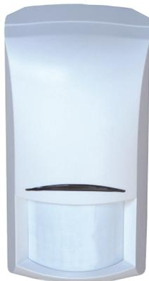
Le Détecteur de Mouvement Radio est un détecteur infrarouge passif conçu pour surveiller une pièce et transmettre sans fil des alarmes à l'appareil de télé-assistance. Le détecteur peut être utilisé conjointement aux appareils de télé-assistance Modèles 3100, 50, 52+, 10 ou 12.
