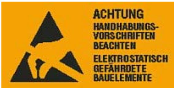
**Zur Vorbeugung von Elektronikschäden ist eine geerdete Reparaturmatte bzw. Armband zu benutzen.**
