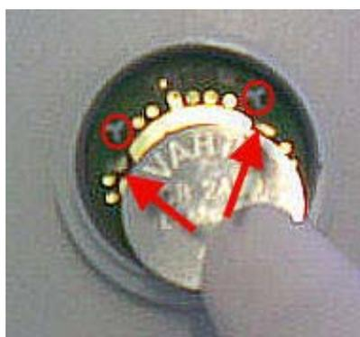
Batterie unter die beiden Halterungen schieben, so dass sie festhält.
