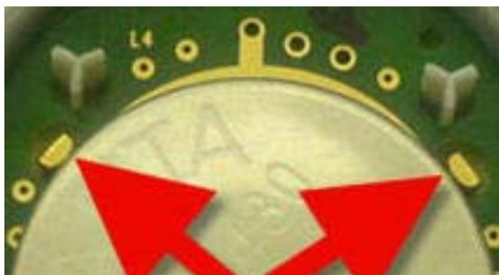
Unterbodendeckel aufsetzen, an beide Aussparungen durch leichtes hin- und Herdrehen in Position bringen.
