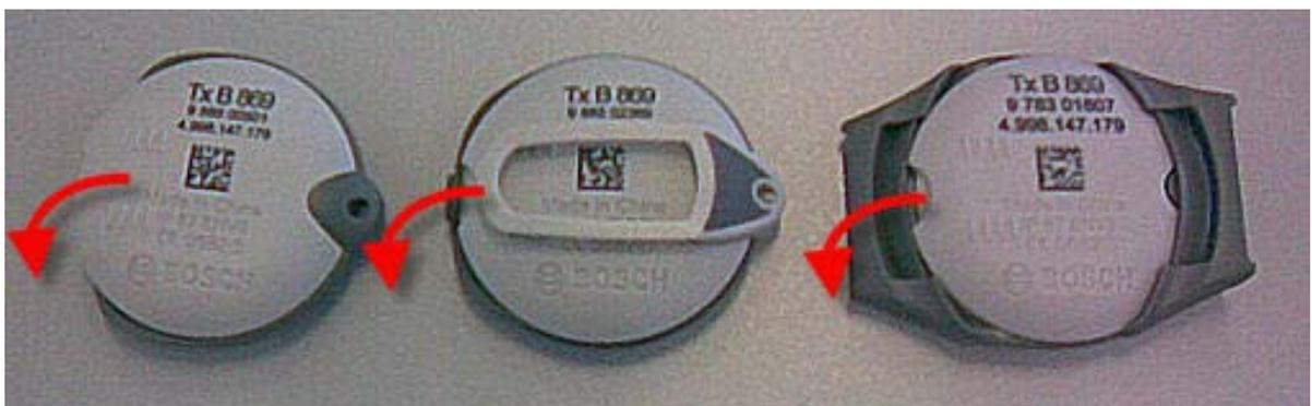
Die Kerbe ober- und unterhalb des Gehäuseöffner-Werkzeugs muss in die dafür vorgesehenen Einbuchtungen am Funkfinger positioniert werden.
