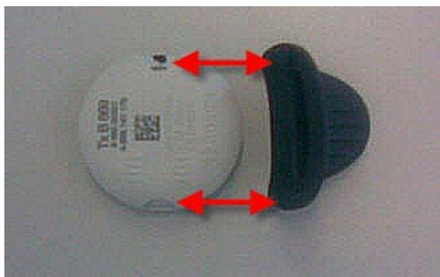
Zum Öffnen benutzen Sie das Gehäuseöffner-Werkzeug, **mit kurzer Drehung nach links.**
