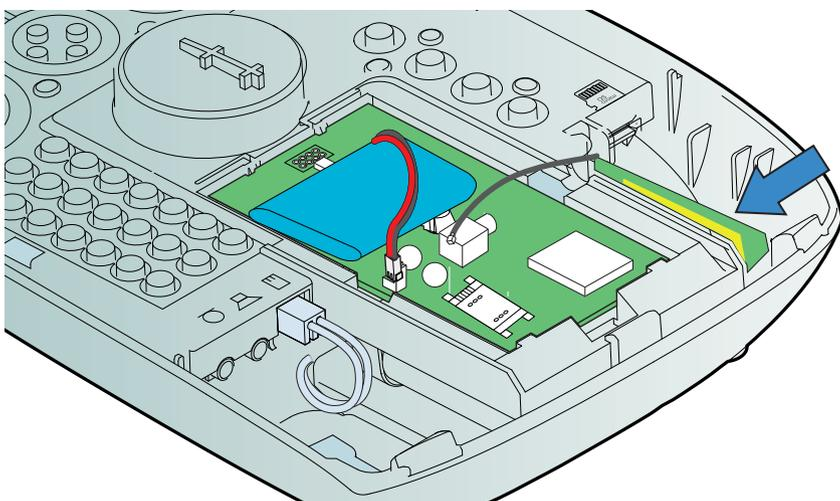
4. Appuyez fermement sur le côté de l'antenne afin que la bande adhère au boîtier.
