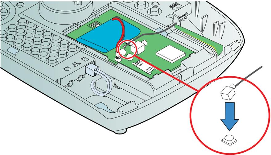
6. Connectez avec précaution l'antenne interne en branchant le petit connecteur dans la prise.
