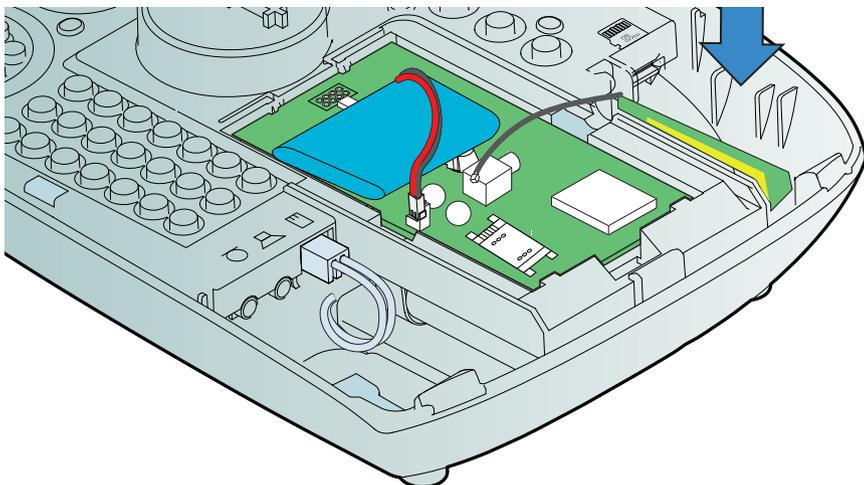
3. Insérez avec précaution l'antenne interne dans la glissière. Assurez-vous que le rail de guidage inférieur est inséré et que la bande adhésive est en contact avec le boîtier. Le bord supérieur de l'antenne doit se trouver au même niveau que le bord du boîtier.
