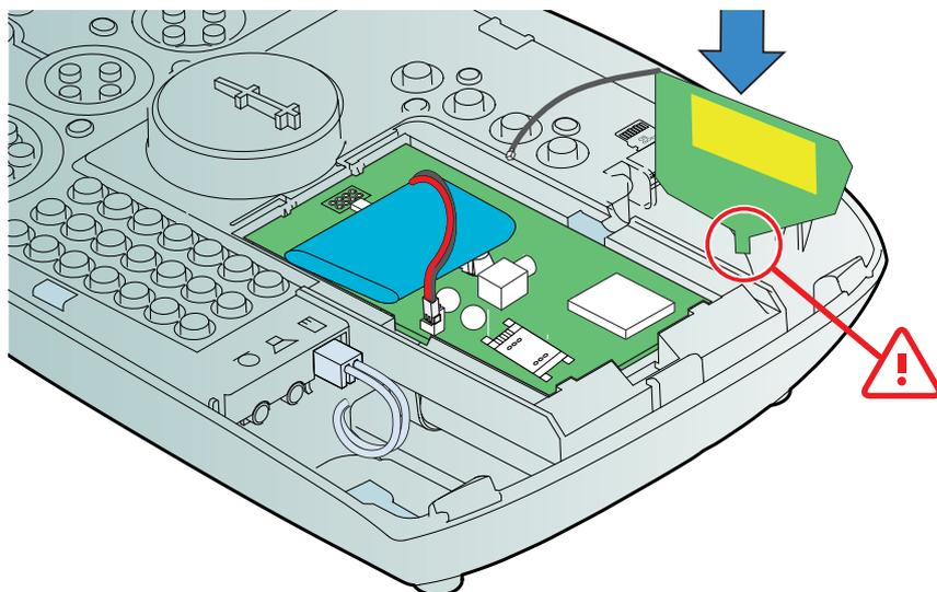
2. Aligned la carte de l'antenne interne le long de l'emplacement réservé sur le côté du Module GSM. Repérez le rail de guidage inférieur (cercle rouge) et la bande adhésive double face (cadre jaune). Retirez le film de protection sur la bande adhésive.
