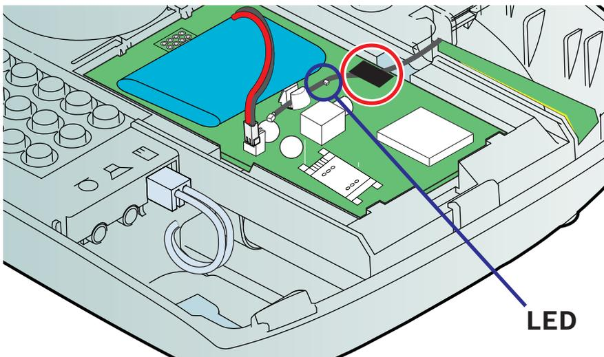
8. Collez la petite bande adhésive (cercle rouge) sur le câble de l'antenne interne. Ne couvrez pas le voyant LED du Module GSM.
