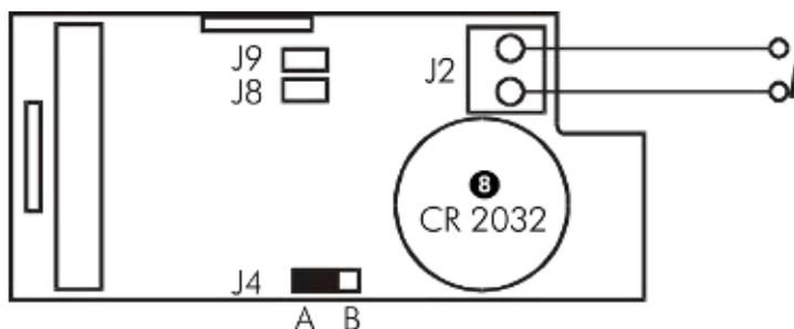
Le raccordement et la configuration doivent être effectués avant la mise en place de la pile.
