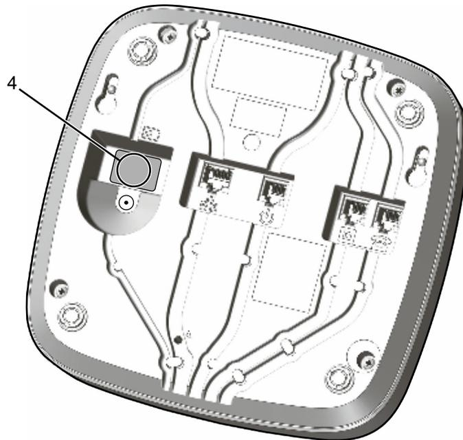
1. Entfernen Sie die Abdeckung des SIM-Kartensteckplatzes (4).
