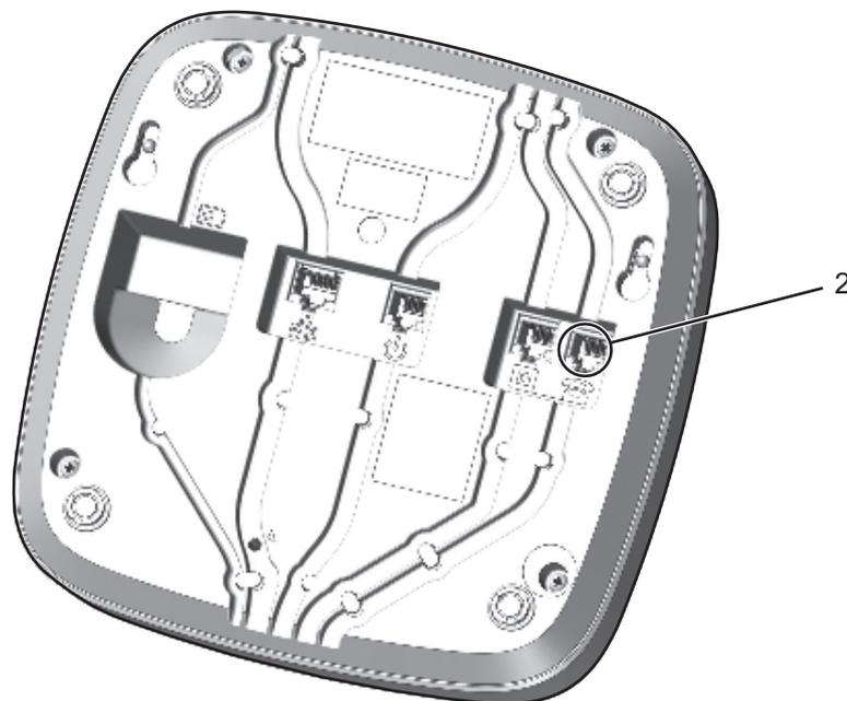
1. Stecken Sie den Stecker des externen Telefonkabels in die entsprechende Buchse **(2)** am TA74. Führen Sie das Kabel durch den Kabelkanal und durch die Öffnung auf der Rückseite des Geräts.
