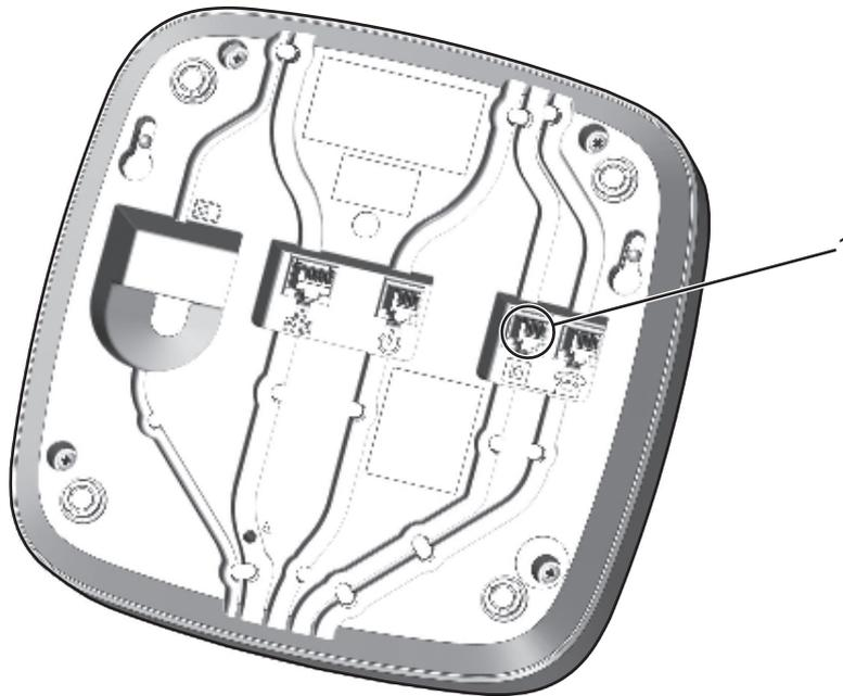
1. Stecken Sie den Stecker des Telefonkabels in die entsprechende Buchse (**1**) am TA74. Führen Sie das Kabel durch den Kabelkanal und durch die Öffnung auf der Rückseite des Geräts.
