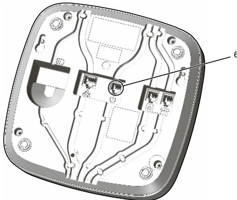
1. Stecken Sie den Stecker des Netzteils in die entsprechende Buchse **(6)** am TA74. Führen Sie das Kabel durch den Kabelkanal und durch die Öffnung auf der Rückseite des Geräts.
