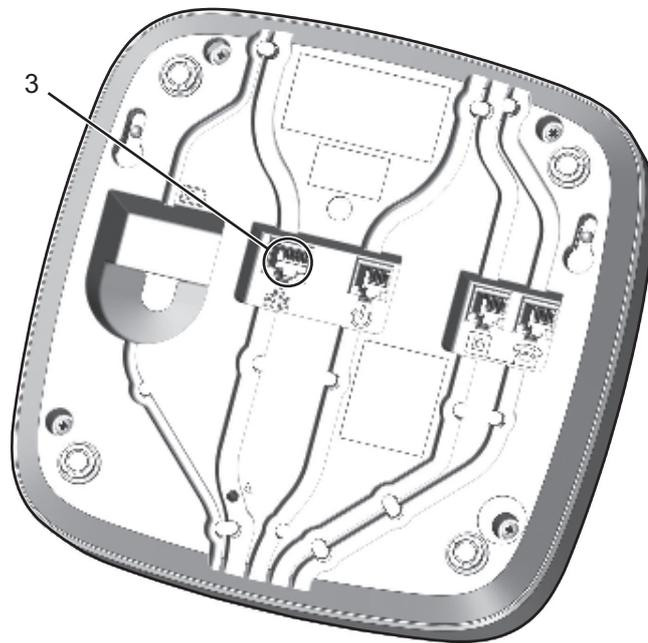
1. Stecken Sie den Stecker des Netzkabels in die entsprechende Buchse **(3)** am TA74. Führen Sie das Kabel durch den Kabelkanal und durch die Öffnung auf der Rückseite des Geräts.
