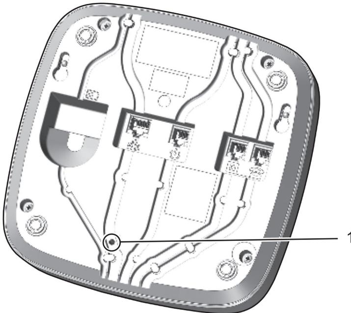
Verwenden Sie zum Drücken der **Wartungstaste (1)** einen langen, dünnen Gegenstand, z. B. eine aufgebogene Büroklammer.
