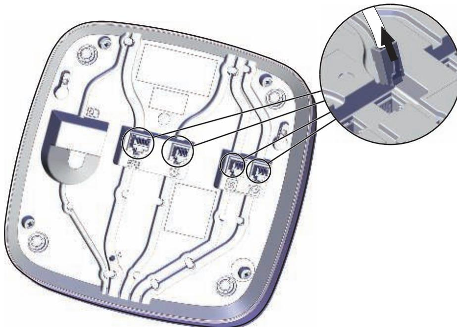
2. Lösen Sie die vier Schrauben an der Unterseite des Geräts und entfernen Sie die untere Abdeckung.
