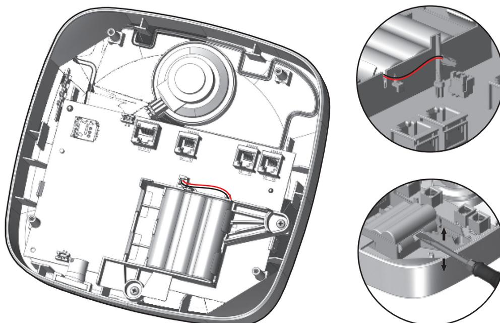
5. Setzen Sie den neuen Akku ein, indem Sie ihn unter eine der beiden Halterungen führen.
