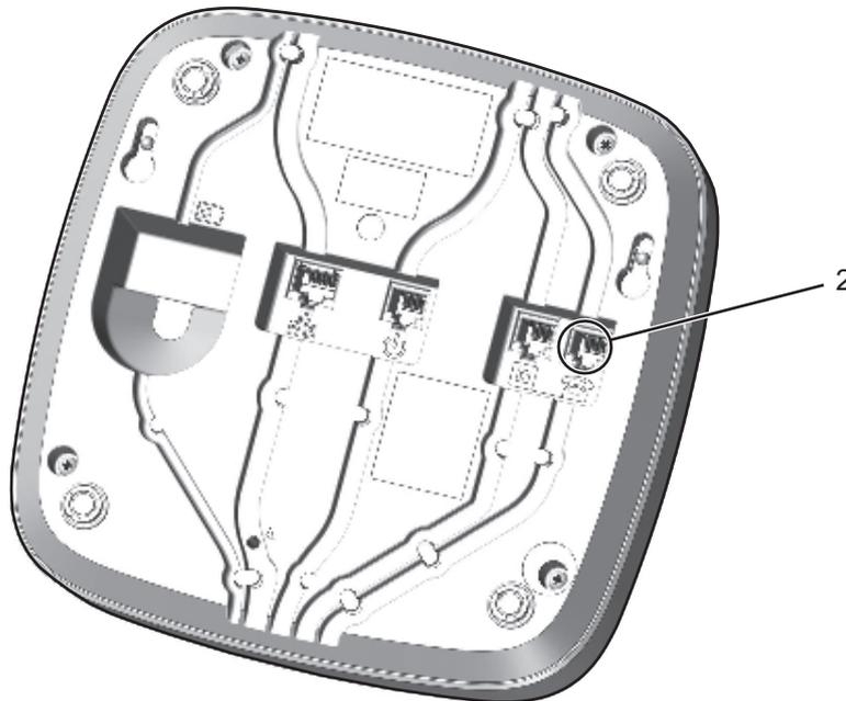
Für den internen Eingang/Ausgang des TA74 GSM IO verwenden Sie die externe Telefonbuchse **(2)**.
