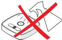
Wenn Flüssigkeit in die Lautsprecher oder Tasten des TA74 gerät, halten Sie das Gerät einfach mit der Oberseite nach unten, um sämtliche Flüssigkeit aus dem Gerät zu entfernen. Schütteln Sie das Gerät bei Bedarf leicht. Führen Sie einen Test durch, um die ordnungsgemäße Funktion der Sprachausgabe zu testen (siehe Abschnitt 8.6 „Testanleitung“).
