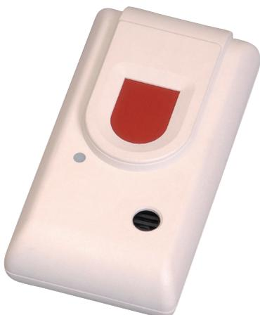
Le détecteur ManDown possède un capteur d'inclinaison intégré qui fonctionne lorsque la personne qui le porte n'est plus en position verticale, et est allongée sur le sol par exemple. Le détecteur envoie automatiquement une alarme lorsque sa position indique une perte de verticalité durant un certain laps de temps. Toute pression sur le bouton rouge au centre active automatiquement un appel à l'aide.
