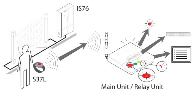
L'émetteur bracelet S37E équipé de la fonction de localisation fonctionne avec les appareils suivants :
